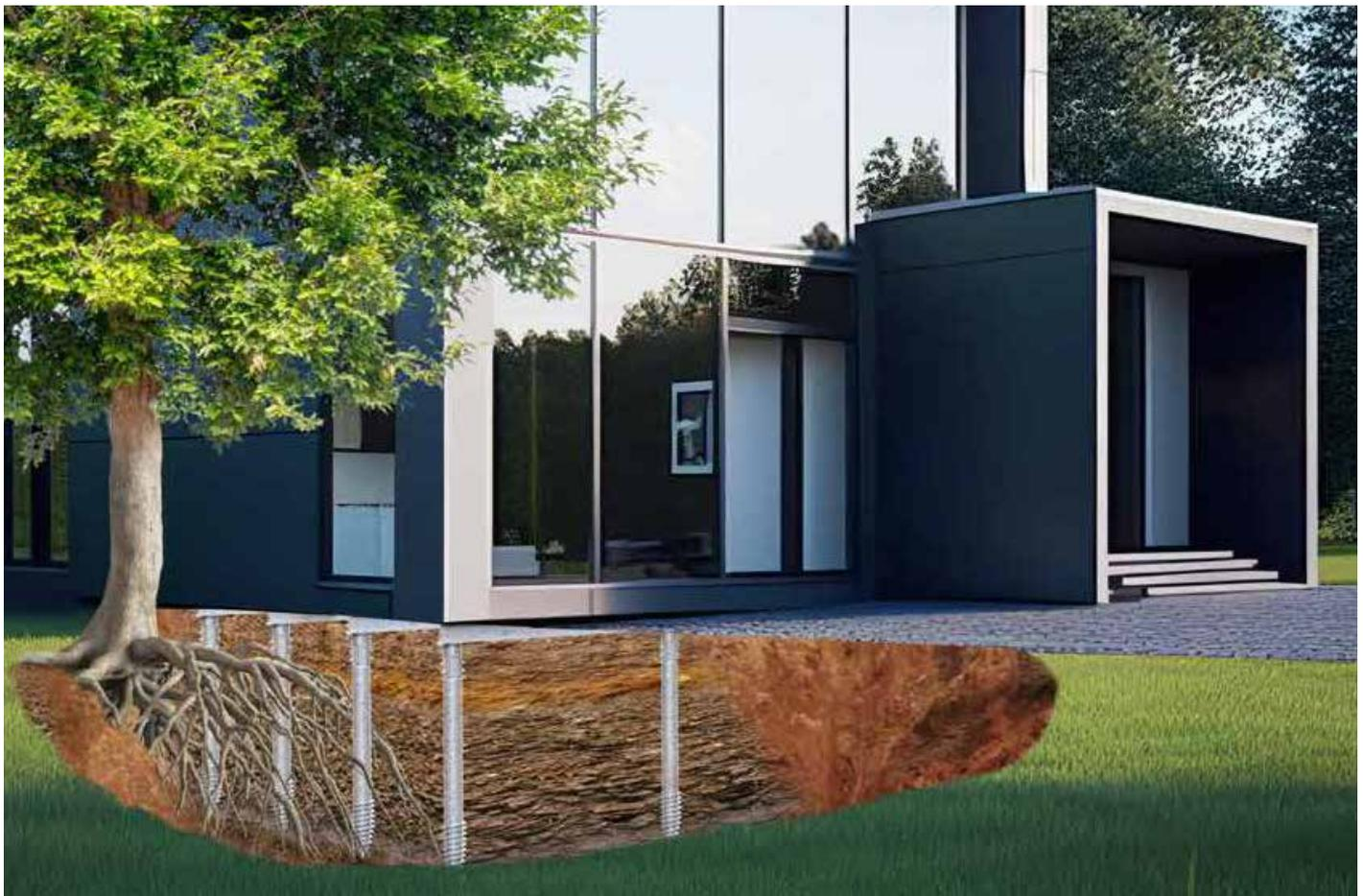
*Es besteht die Möglichkeit, die Schraubfundamente zwischen vorhandenen Wurzeln zu montieren, und so den Baum zu erhalten.*
